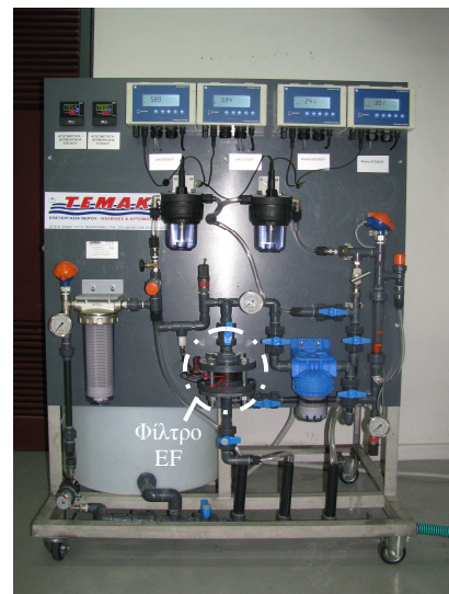
Σχήμα 1. Σχηματική αναπαράσταση α) “φίλτρου” EF πολλαπλών ζευγών ηλεκτροδίων ανόδου/καθόδου, β) πιλοτικής μονάδας EF.
