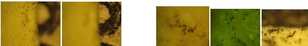
Εικόνα 6 Αποκόλληση μελάνης από την μηχανική αφαίρεση του post-it™ στις εφημερίδες αρχείου - Εμφανής επικόλληση της μελάνης στα μικροσφαιρίδια της κόλλας
